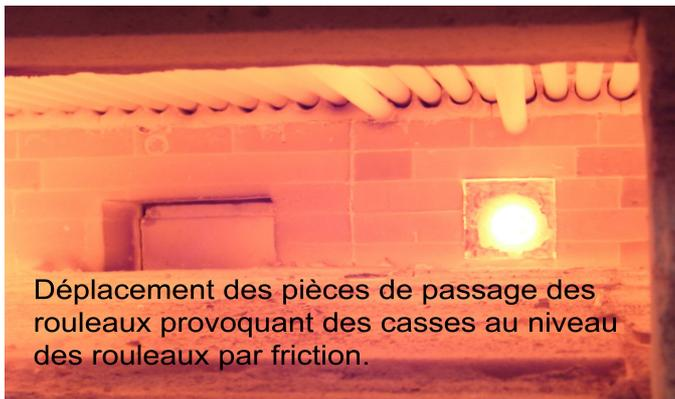
Déplacement des pièces de passage des rouleaux provoquant des casses au niveau des rouleaux par friction.
