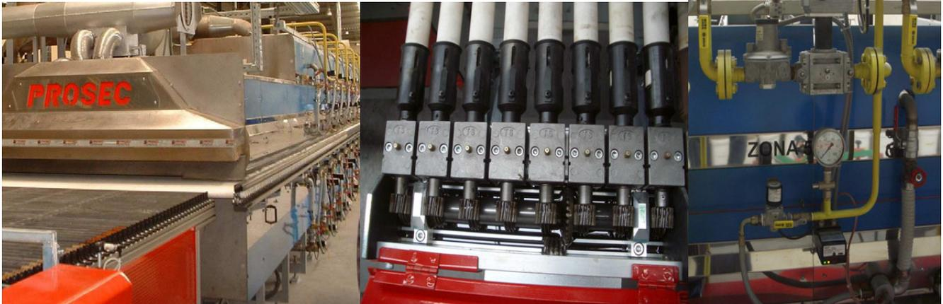
Diseñado y desarrollado como el horno mas versátil del mercado su principal característica se la proporciona el revestimiento interior, de ladrillos aislantes ligeros bajo el plano de rodillos y de fibra cerámica de última generación en la parte superior (con baja inercia térmica, muy inferior a la del ladrillo, mayor capacidad aislante y elevada refractariedad).
